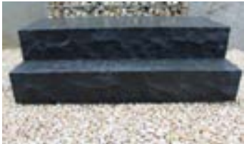
Blockstufen 15/35/100 cm 4 Seiten gesägt und geflammt, Front gespalten
