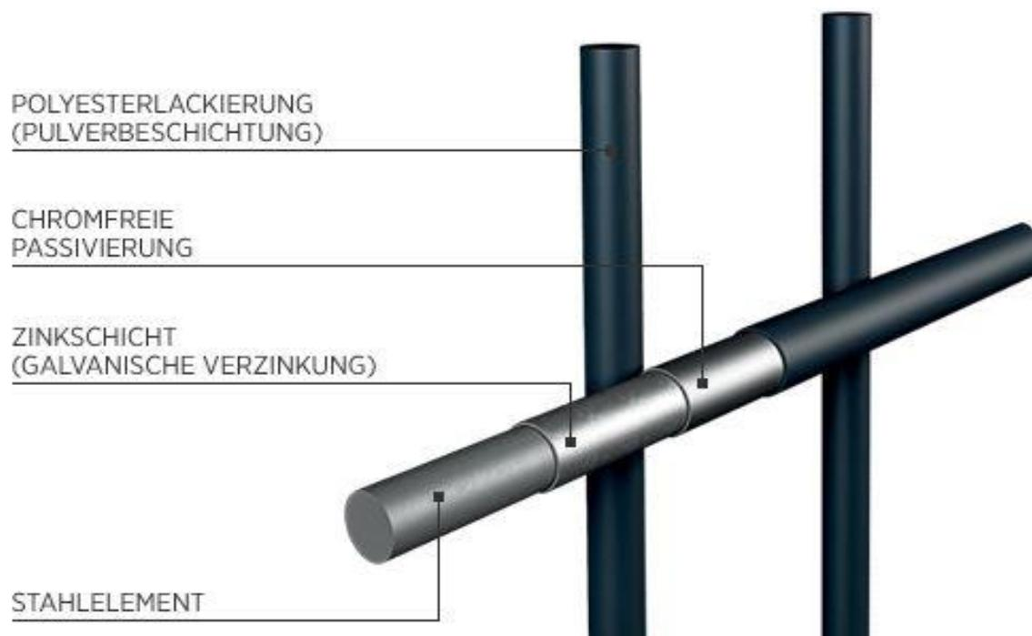
Schichtaufbau variiert je nach Herstellerverfahren
