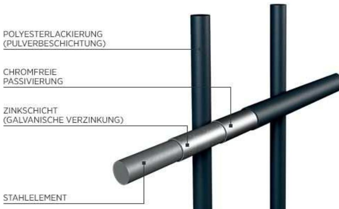
Schichtaufbau variiert je nach Herstellerverfahren
